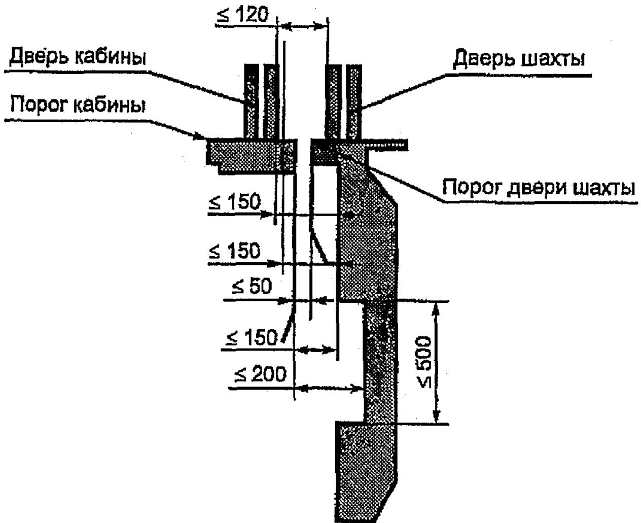
**Рисунок 3 — Расстояние между элементами кабины и шахты**
