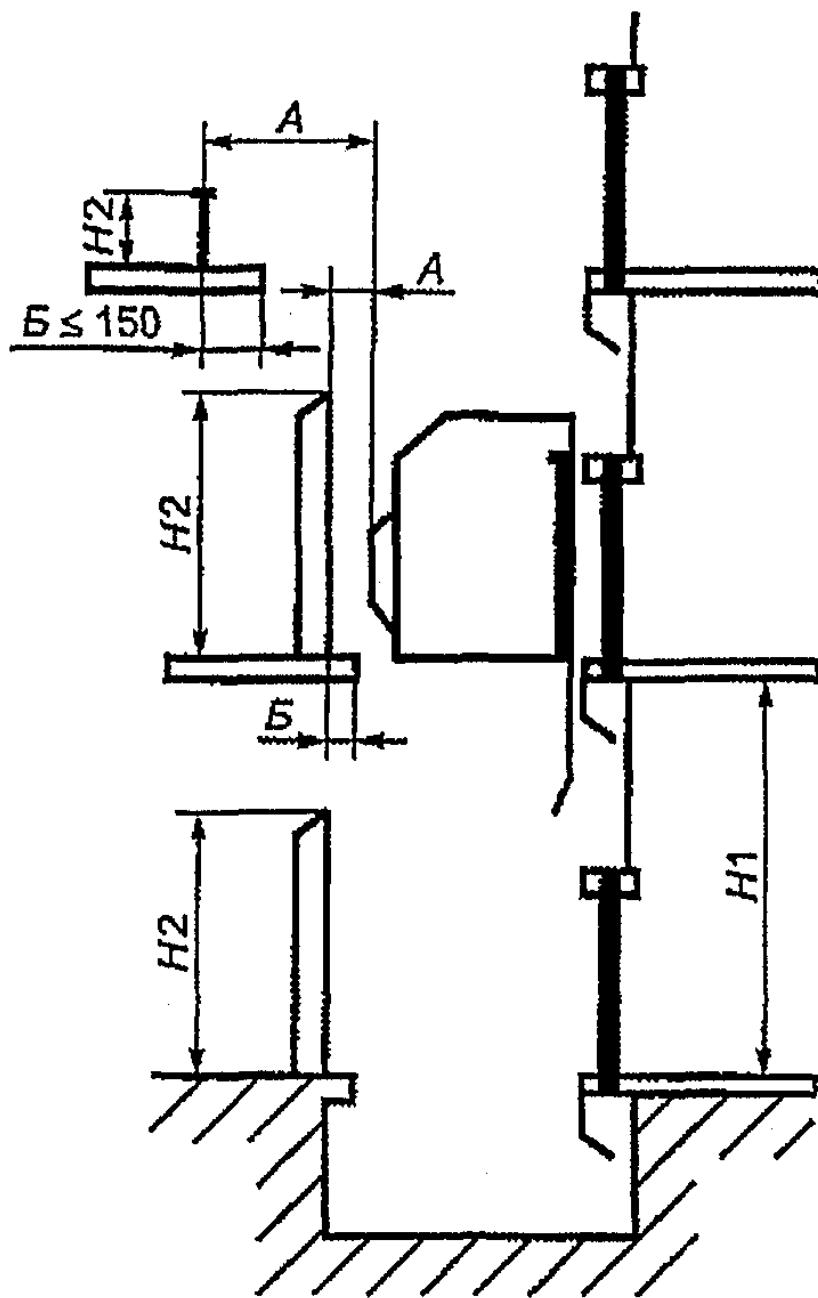
$A$  — расстояние до движущихся элементов лифта;  $B$  — расстояние между ограждением и краем межэтажных перекрытий, ступеней и площадок;  $H_1$  — высота ограждения со стороны этажной площадки;  $H_2$  — высота ограждения с остальных сторон
